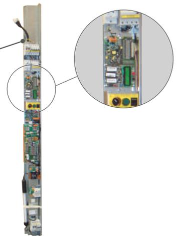
► Armoire de manœuvre dans le montant de la porte.
