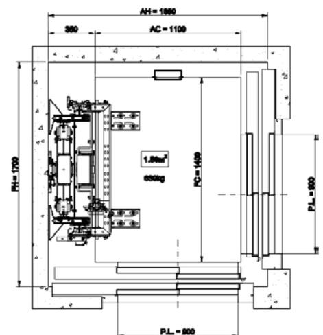
(1) Données pour installations à 1m/s. Hauteurs sous dalles calculées avec une hauteur cabine intérieure utile de 2.005mm.
